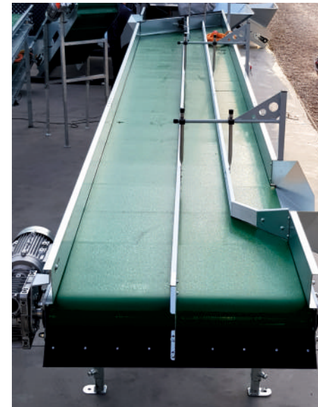
BANDĂ TRANSPORTOARE tipul: 50x600 Bandă transportoare pentru încărcarea remorcilor de max. 2.5m
